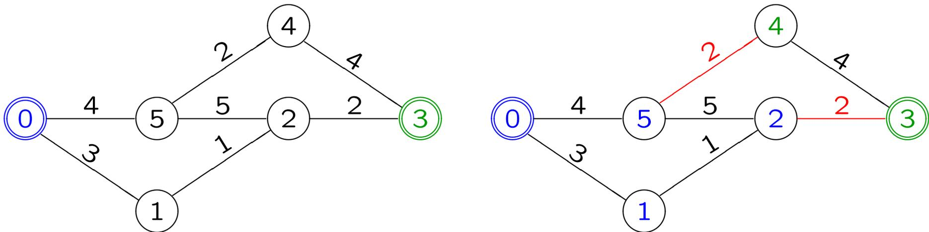
Como obter (os arcos de) um **corte 0–3 mínimo** no grafo **não orientado e pesado**?
