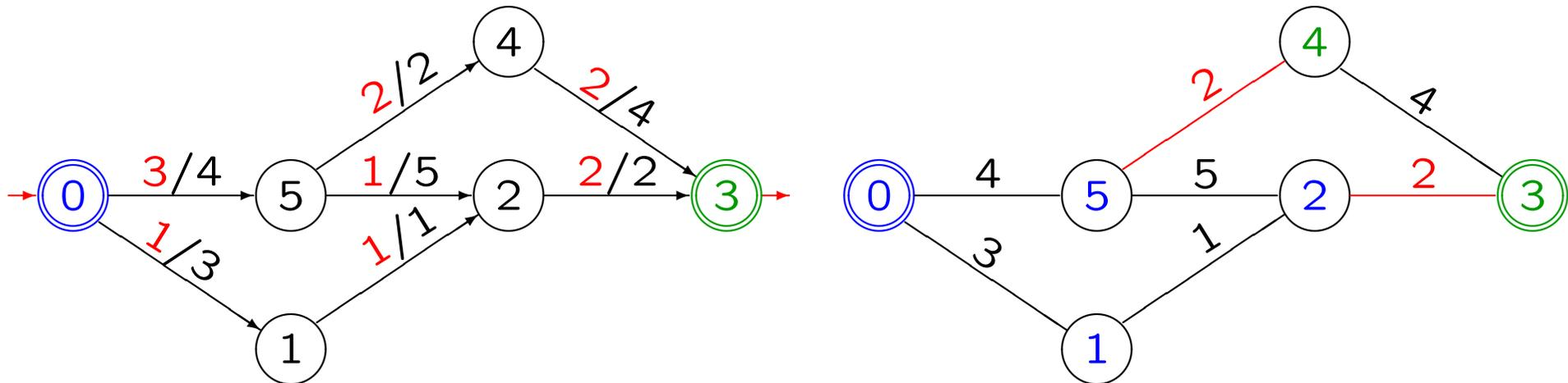
1. Calcula-se um fluxo máximo  $\phi$  de 0 para 3 no grafo orientado correspondente (figura da esquerda, omitindo os arcos com fluxo  $< 0$ ).
