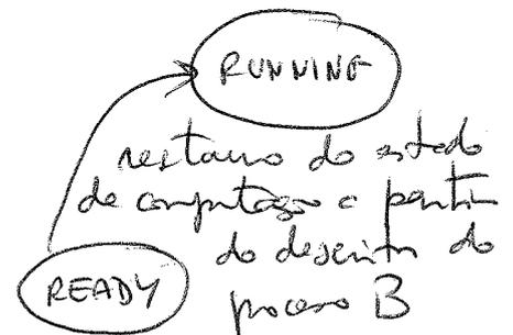
② execução do algoritmo de escalonamento que escolhe, entre os processos no estado READY, B para correr
